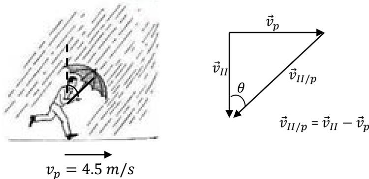
Del triángulo de velocidades con  $\vec{v}_{II}(\downarrow)$  y  $\vec{v}_p(\rightarrow)$ , deducimos que se ve caer las gotas con la velocidad relativa  $\vec{v}_{II/p}(\swarrow)$ , cuyo módulo lo determinamos mediante
