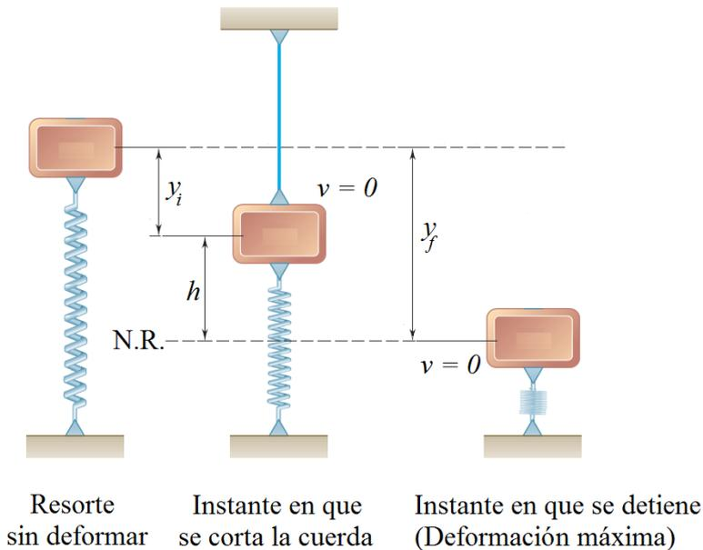
La deformación máxima ocurre cuando la velocidad es cero, por lo tanto usamos el método energético entre el punto donde se corta la cuerda (resorte comprimido una distancia  $y_i$ ) hasta el punto donde la velocidad es cero, donde el resorte se ha comprimido una distancia  $y_f$ , y el bloque ha descendido una distancia  $h = y_f - y_i$ .
