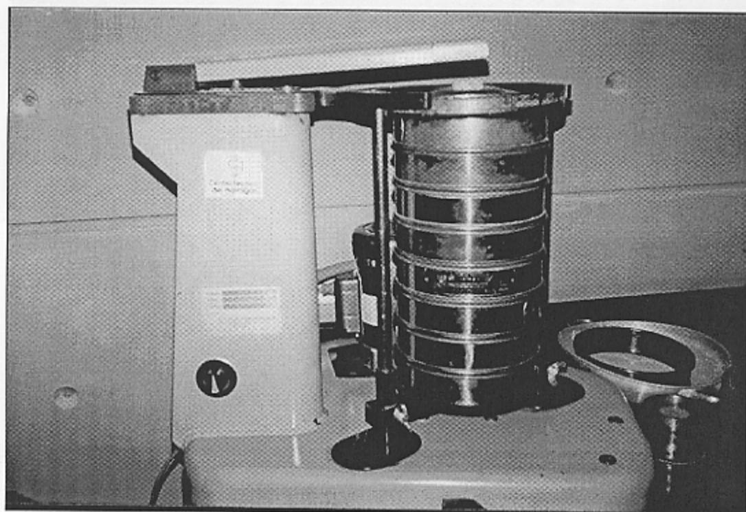
FOTO #2.- Tamizadora de Agregado Fino.
