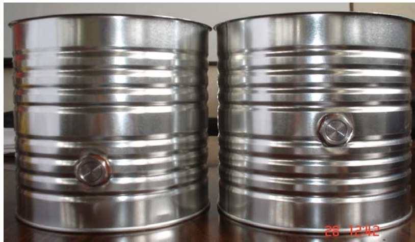
FIGURA 2.2 Vista frontal de la ubicación de sensores en envases 603x600
