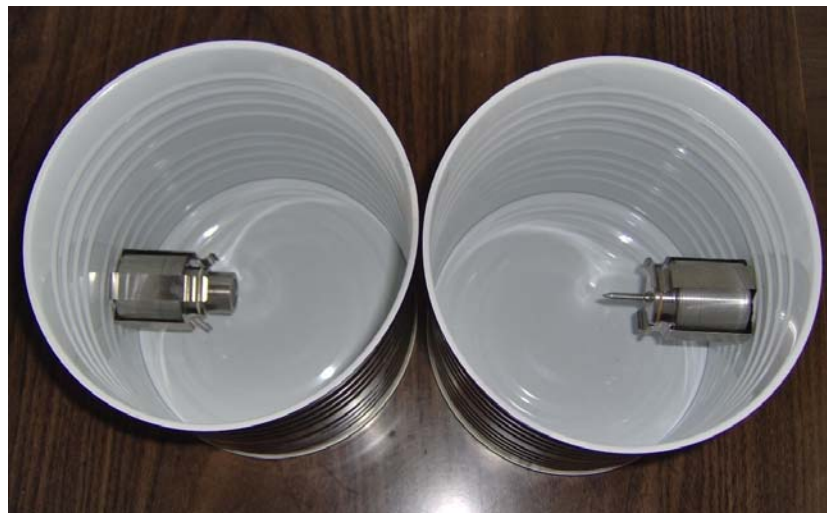
FIGURA 2.3 Vista superior de la ubicación de sensores en envases 603x600
