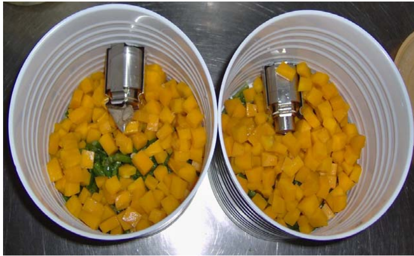
FIGURA 2.4 Ubicación de sensores a lo largo del eje axial del envase 603x600
