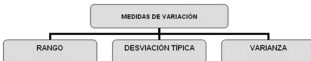
**Rango:** Diferencia entre el valor máximo y mínimo de un muestra o población. Sólo es valido en variables continuas. Amplitud.
