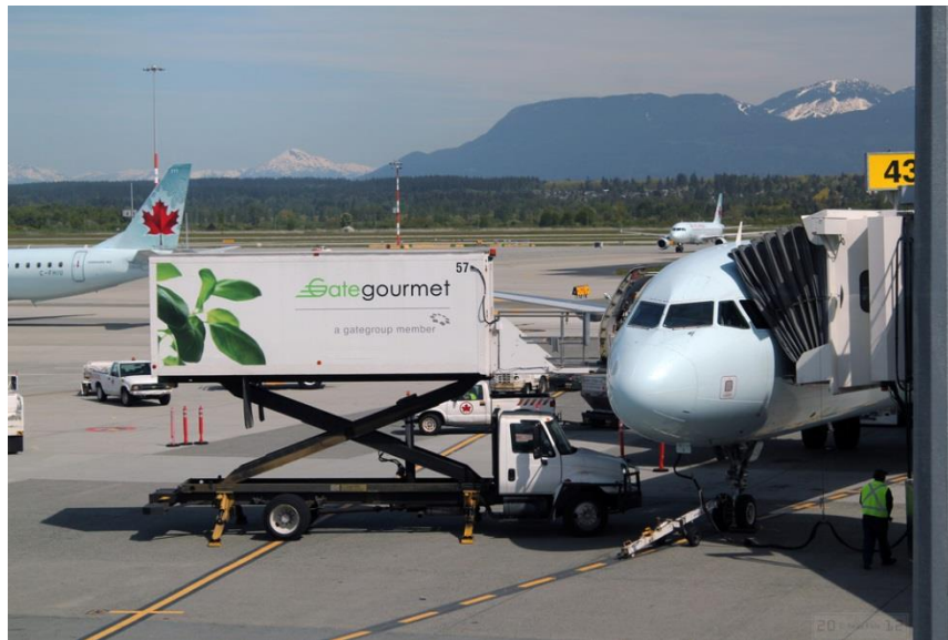
Figura 3.3 Camión de carguío servicios de catering
