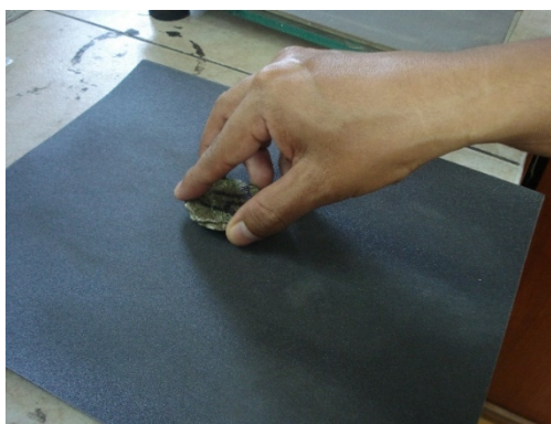
Figura 3.14 Desbaste grueso con lijas
