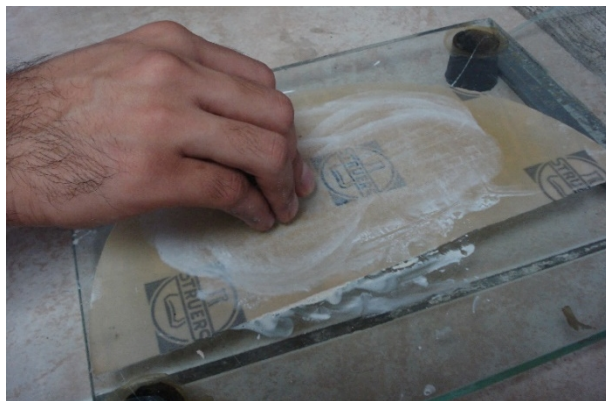
Figura 3.16 Pulido fino en paño Struers
