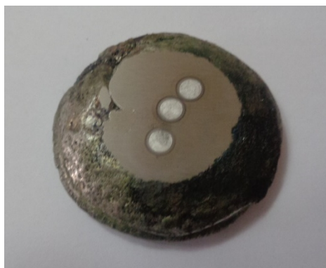
Figura 3.7 Colada analizada por equipo Leco GDS 500A
