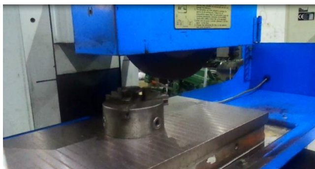
Figura 3.5 Proceso de rectificado
