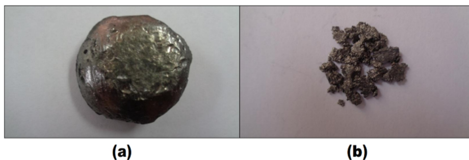
Figura 2.13 Muestra de níquel en (a) Colada (b) Trizas
