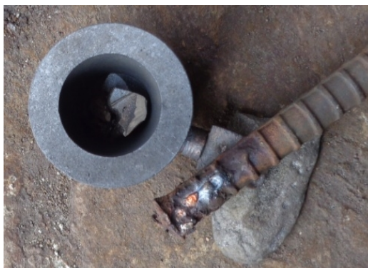
Figura 2.14 Puesta de materiales en el crisol
