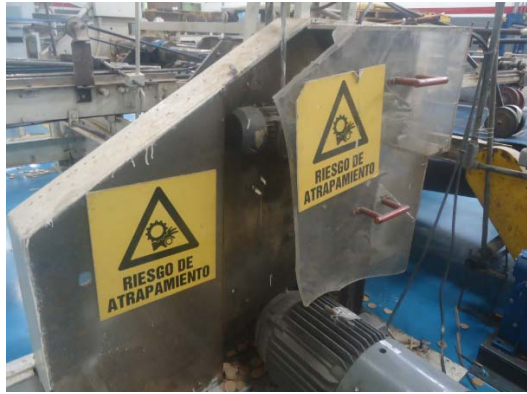
Figura 3.18. Señalética de Riesgo de Atrapamiento colocada en máquina impresora.
