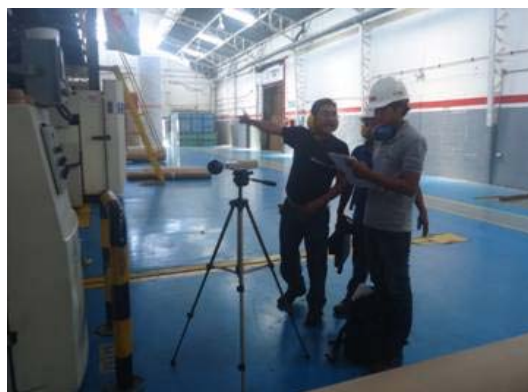
Figura 3.11. Muestra de ruido tomada en la Flauta C del Corrugador.
