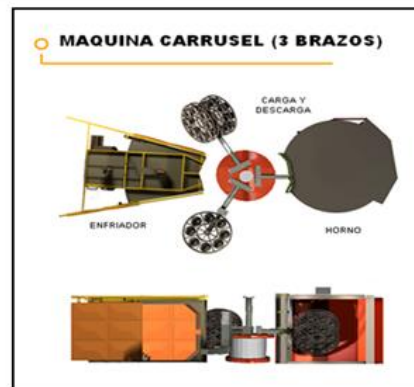
Figura 3.3 Esquema de maquinarias de rotomoldeo
