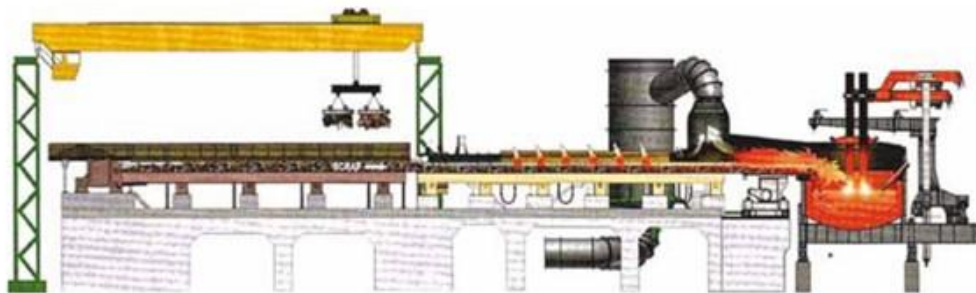
Figura 5. Sistema de calentamiento Consteele y Horno de Arco Eléctrico.
