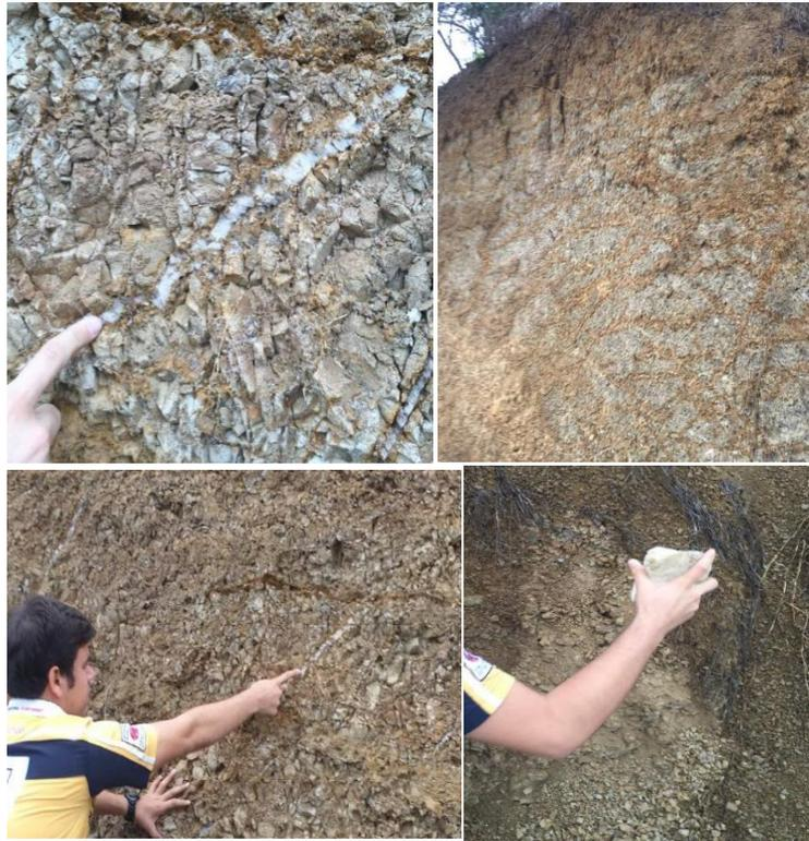
**Figura 3.9.** Fotografía de los cortes presentes en el terreno, se observa suelo residual de roca sedimentaria tipo lutitas y limolitas con presencia de discontinuidades de yeso.
