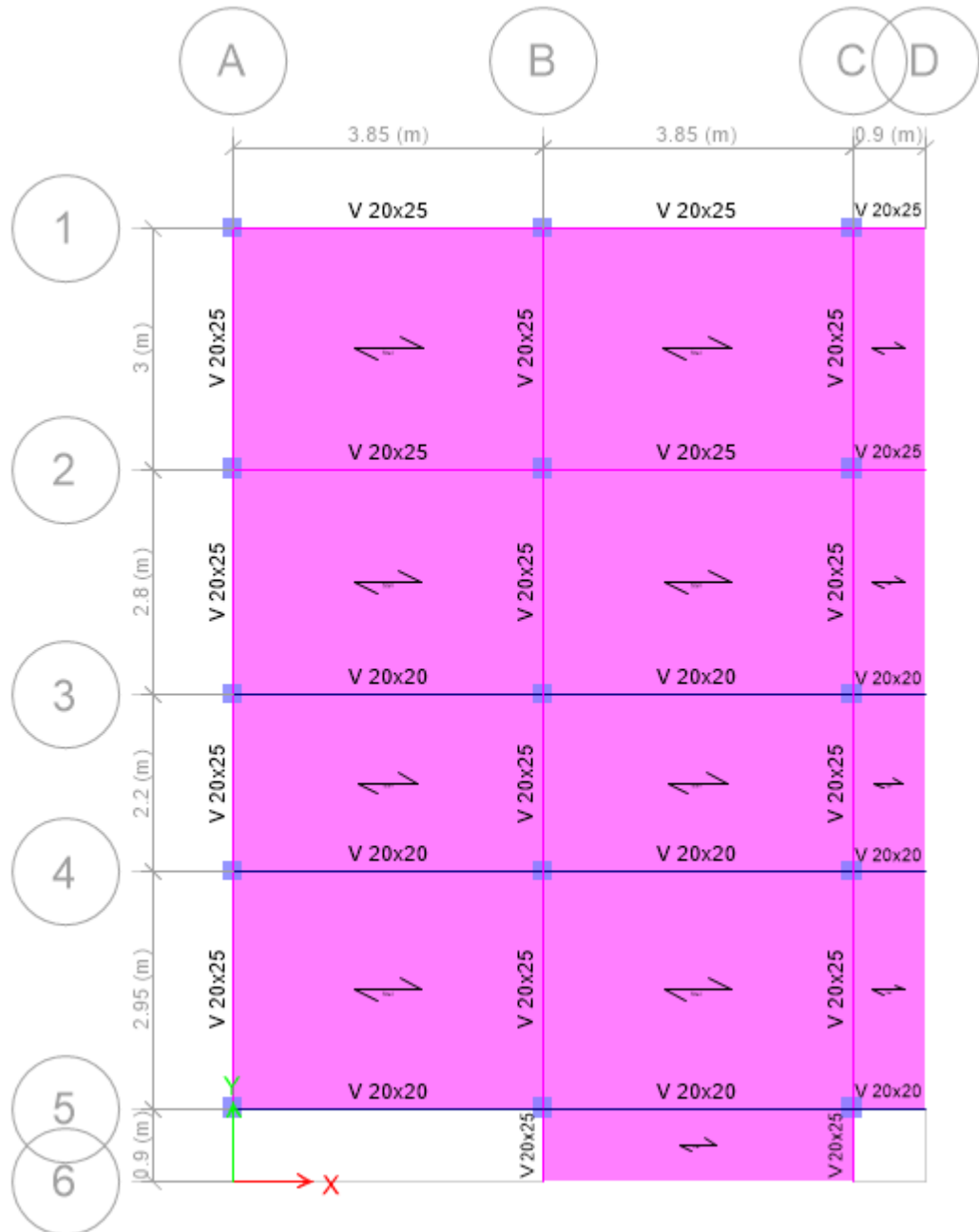
Figura Secciones de elementos estructurales Viga (NIVEL+3.00 m).
