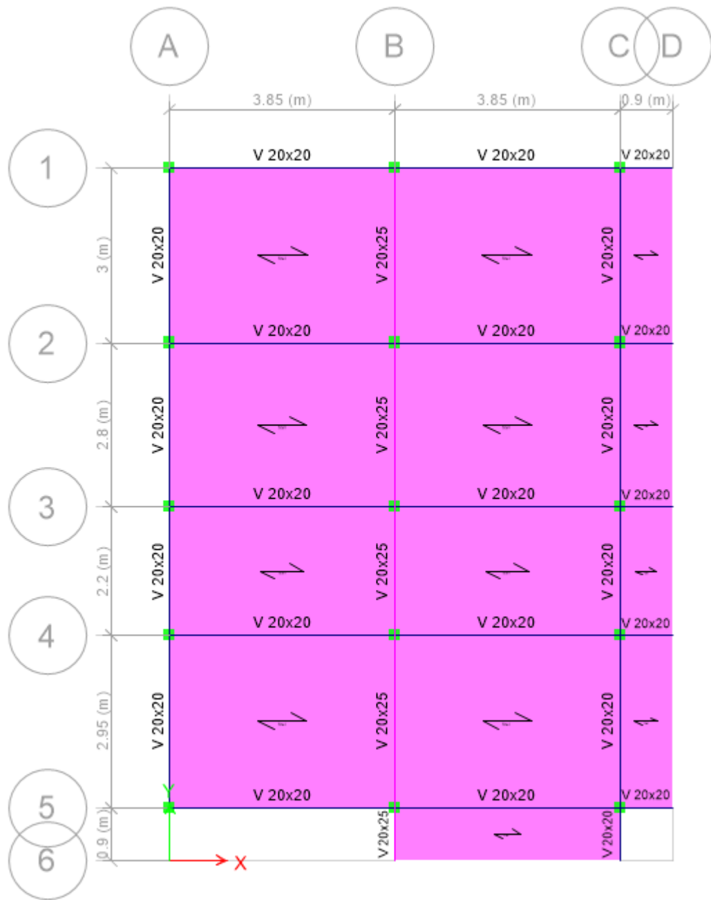
Figura Secciones de elementos estructurales Viga (NIVEL+6.00 m). Losa de steel panel: espesor de hormigón 5.0 cm, placa colaborante 1mm Fuente: Propia
