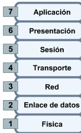
Figura 2.7 Capas del modelo OSI. [10]
