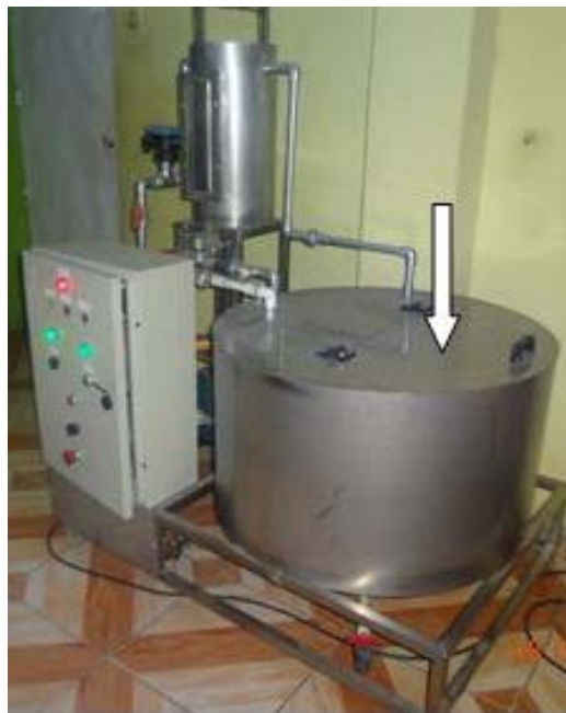
FIGURA 3.3. Tanque de almacenamiento de agua
