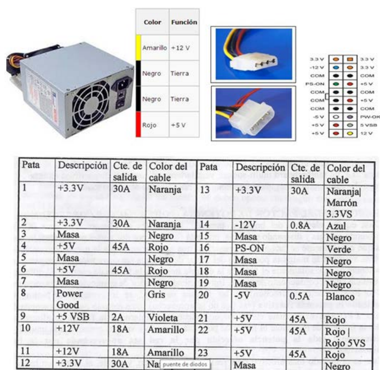
FIGURA 3.10. Fuente de alimentación del tipo ATX [21]
