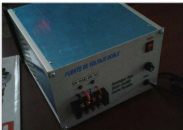
FIGURA 3.13. Fuente de voltaje doble con salida de +Vdc. y -Vdc.
