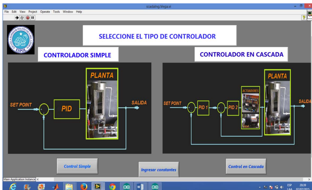
FIGURA 3.27. Pantalla principal del SCADA
