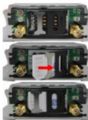
Figura 2.5 Como insertar el chip en el MVT380
