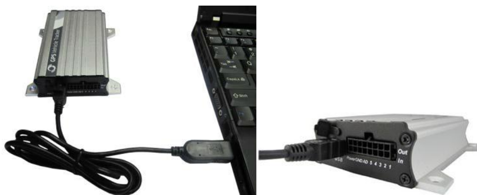
Figura 2.16 Conexión por USB para configurar el MVT380.
