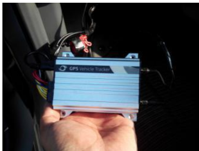
Figura 4.28 Rastreador MVT380 instalado.
