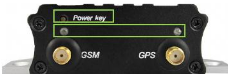
Figura 2.6 Indicadores Led del MVT380
