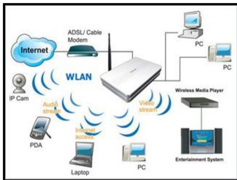
Figura 2.4 Convergencia de dispositivos móviles en la wlan según estándares IEEE y WECA
