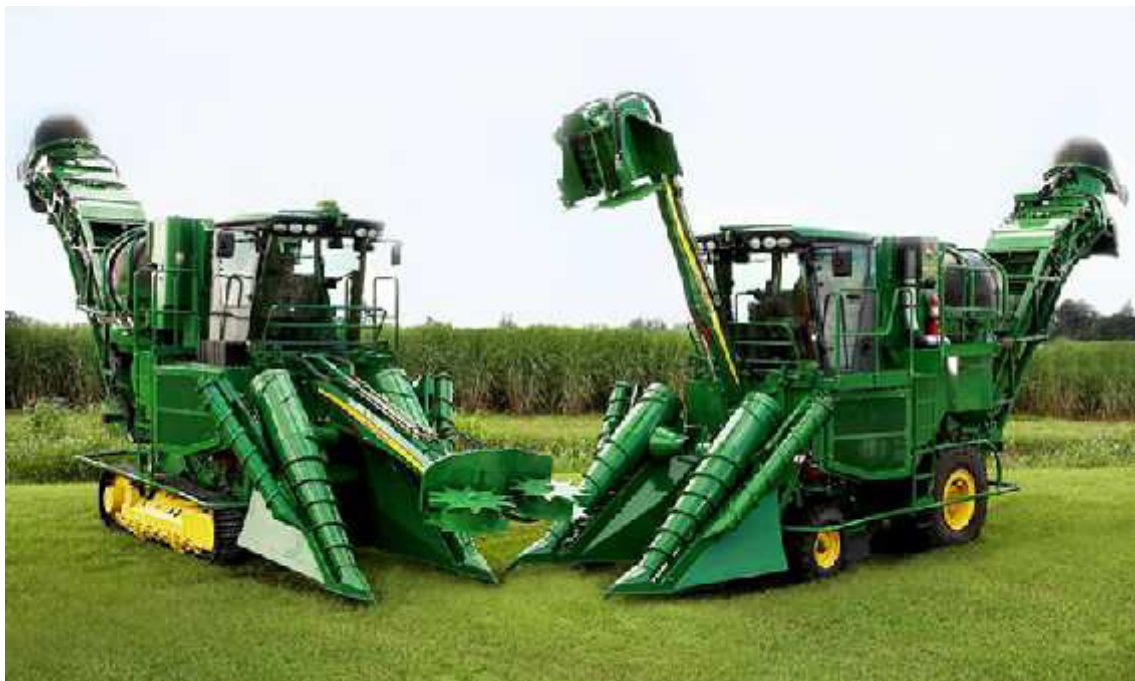
Figura 15: Cosechadoras de caña picada en versión ruedas y oruga
