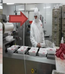
3.2 pasar las bandejas con el producto en la máquina de empaque at modificado.
