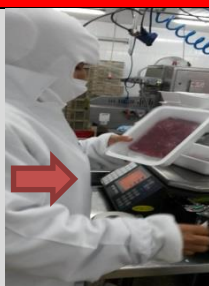
3.3 pesar las bandejas en la balanza etiquetadora.
