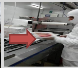
3.8 colocar las bandejas en la máquina de empaque Atm modificado.
