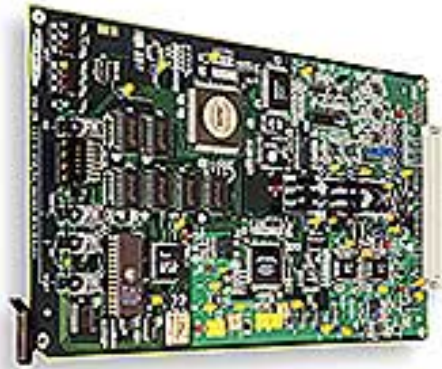
Tarjeta: Conversor Digital-Analógico de video SDM-211i
