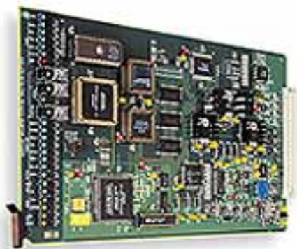
Tarjeta: Conversor Analógico-Digital de video compuesto ASD 211i
