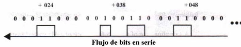
Figura 5.7 Transformación en señal digital de los dígitos binarios
