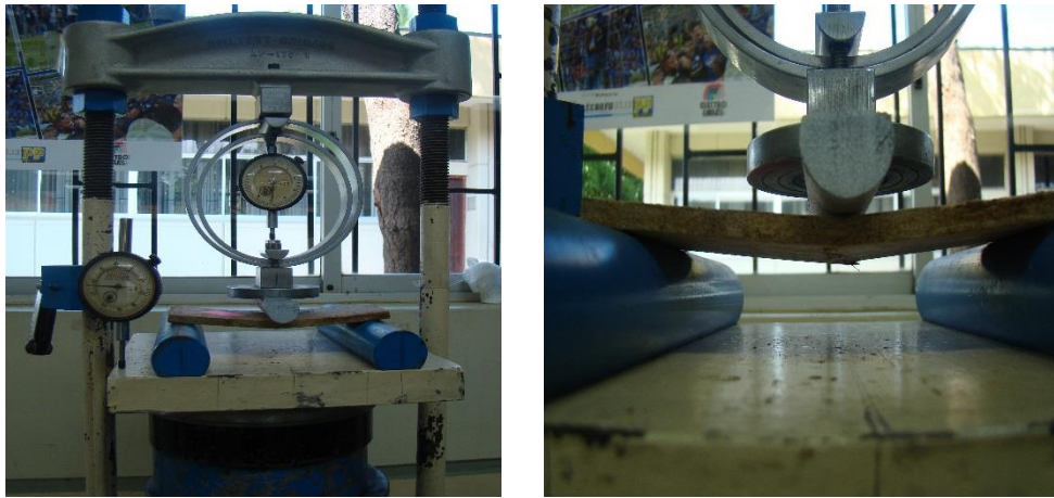
Figura 22. Determinación módulo de rotura y módulo de elasticidad. Elaborado por: Autor
