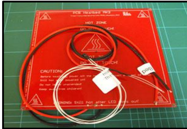
Figura 2.5c: Heated PrintBed (Tablero de Impresión)
