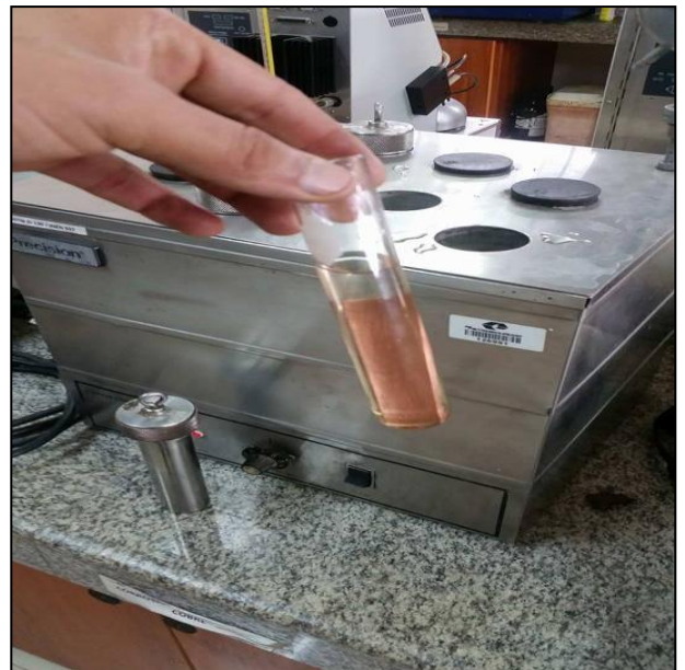
Fotografía 8 Ensayo de la corrosión a la lámina de cobre de la gasolina extra aditivada con el Aditivo B.
