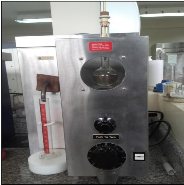
Fotografía 5 Destilación de la gasolina Super con naftalina
