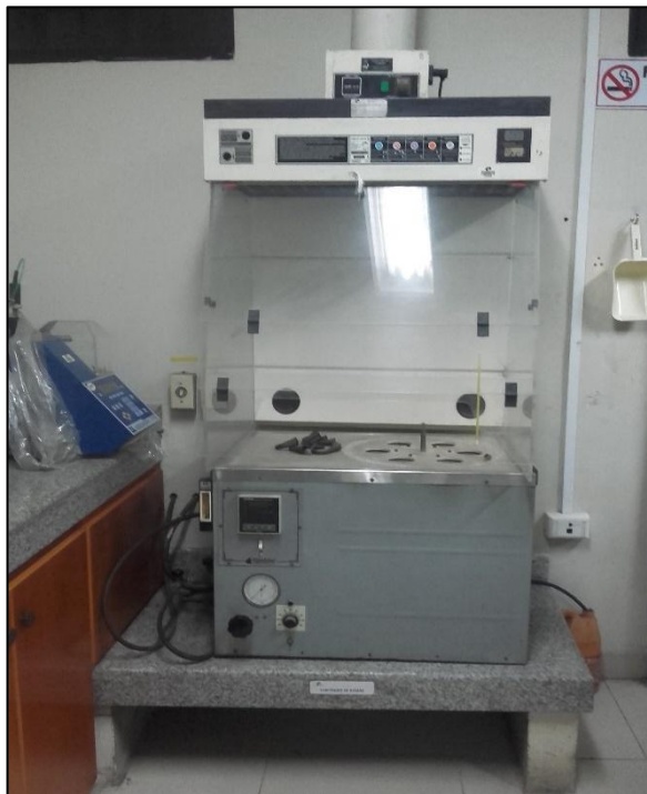
Figura 3.6 Equipo para el ensayo de contenido de gomas
