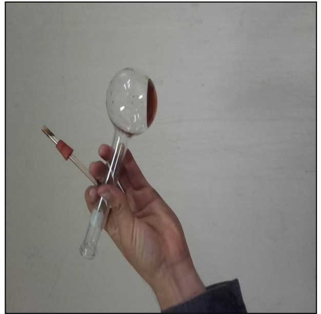
Fotografía 6 Se observa el Residuo de destilación de la gasolina Super aditivada con naftalina.
