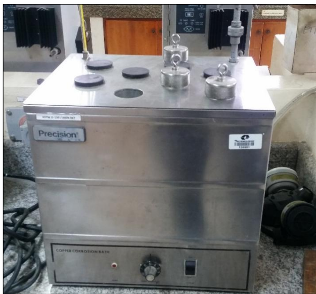
Figura 3.5 Equipo de Corrosión a la lámina de Cobre
