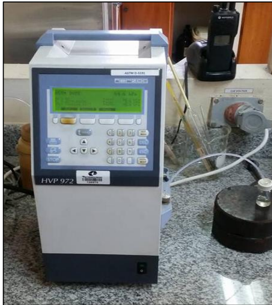
Figura 3.3 Equipo de Presión de Vapor
