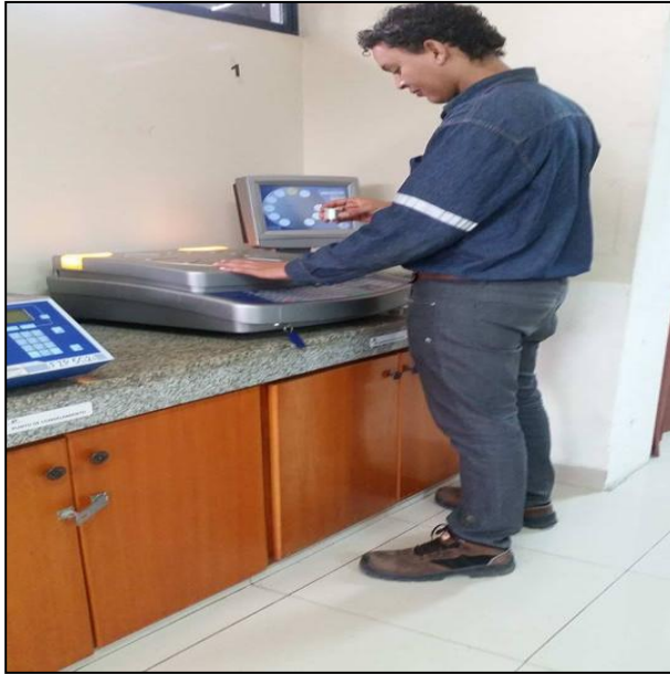
Fotografía 9 Medición del contenido de azufre de las gasolinas con y sin aditivo
