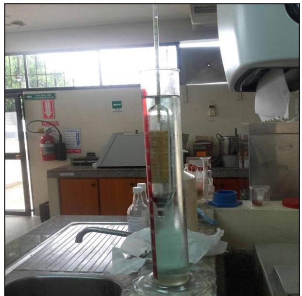
Fotografía 4 Medición de la gravedad API en la gasolina Ecopaís
