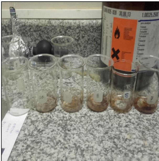
Fotografía 11 Se observa el oscurecimiento de las Muestras luego de la medición del contenido de gomas.
