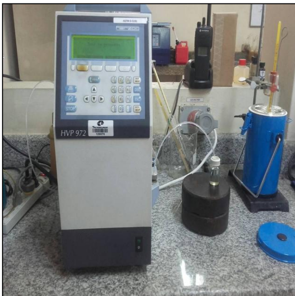
Fotografía 3 Ensayo de medición de la presión de vapor de la gasolina Super aditivada.
