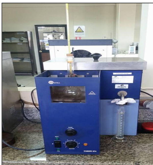
Figura 3.2 Equipo de Destilación ASTM
