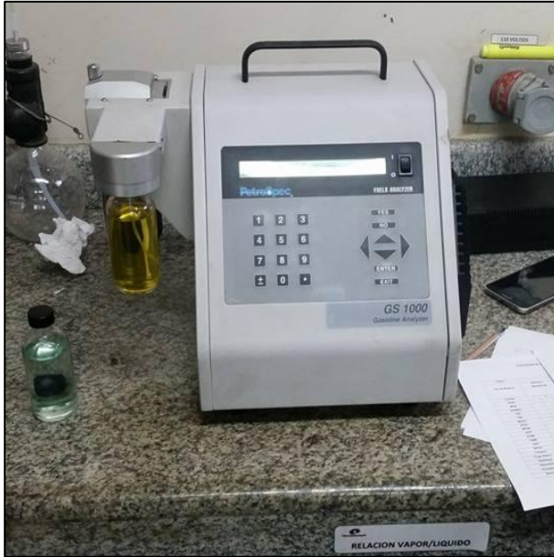
Fotografía 1 Se observa un cambio de coloración en la gasolina Ecopaís aditivada con el Aditivo A.
