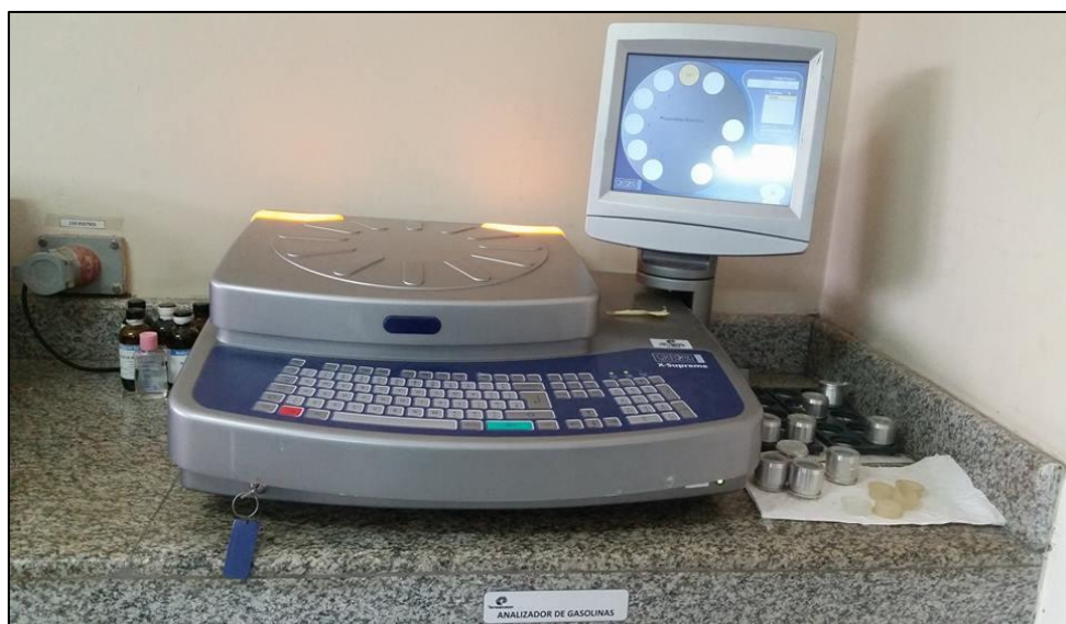
Figura 3.4 Equipo de medición de contenido de azufre
