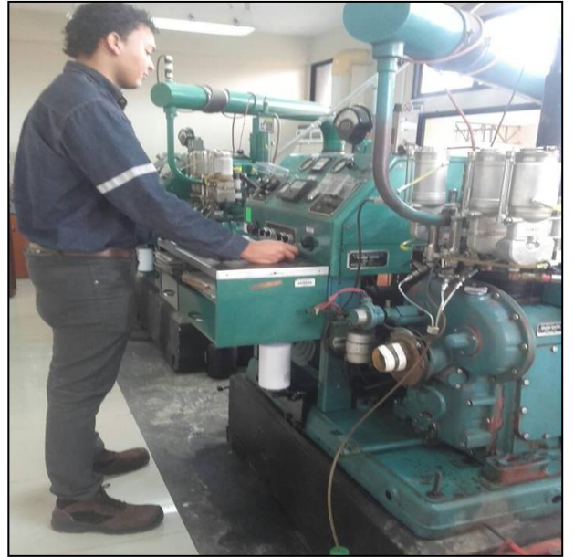
Fotografía 10 Ensayo de Medición del octanaje por el método Research RON
