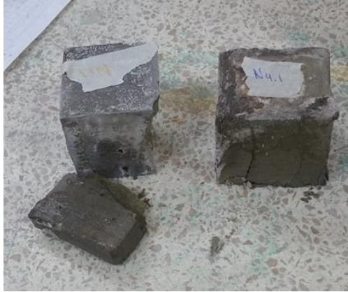
Figura 3.11 Mortero de geopolímero sin fibra y con fibra después de la prueba de compresión
