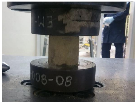
Figura 3.10 Ensayo de resistencia a la compresión
