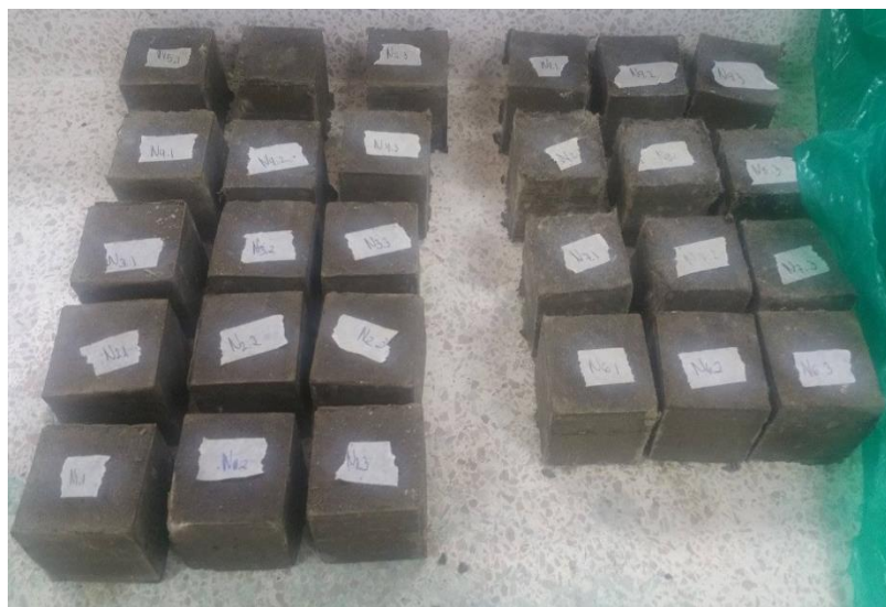
Figura 3.8 Concreto de geopolímero sin y con reforzamiento de PP, conformado por arena 2
