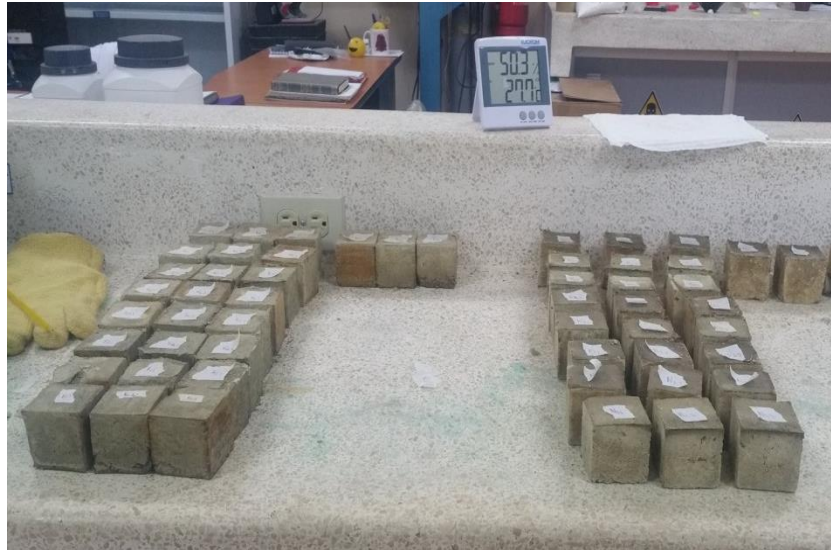
Figura 3.7 Concreto de geopolímero sin y con reforzamiento de PP, conformado por arena 1
