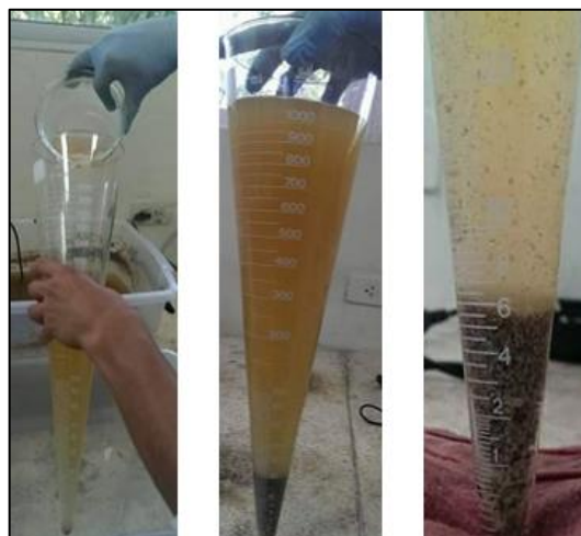
Figura 3.17. Determinación de biomasa en un cono Imhoff por sedimentación
