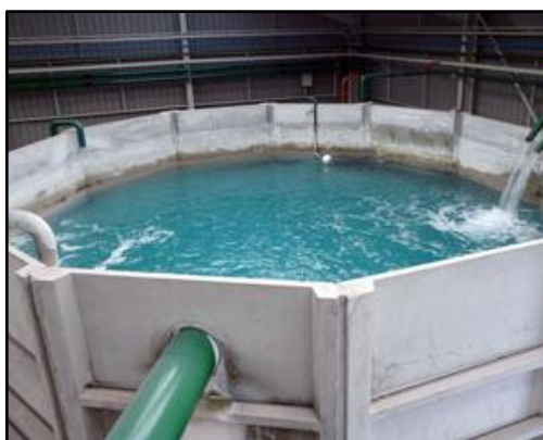
Figura 2.15. Proceso de Neutralización Ácido-Base
