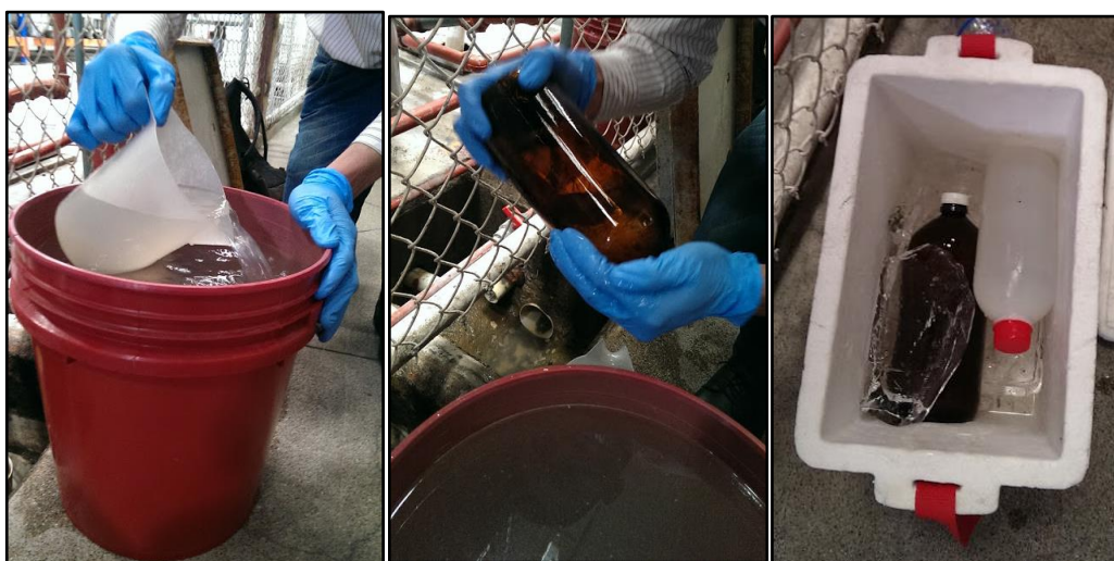
Figura 3.2. Proceso de Toma de la Muestra Compuesta.
