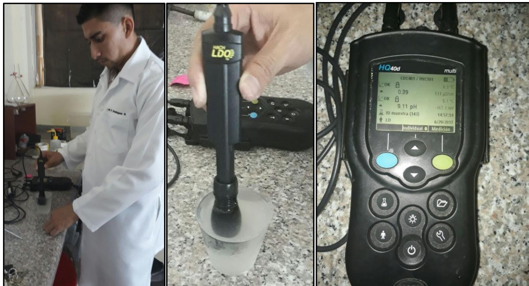
Figura 3.4. Medición de pH, Conductividad y Oxígeno Disuelto en el Multiparámetro.
