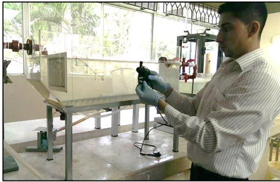
Figura 3.21. Instalación de la Bomba de Aireación Sumergible
