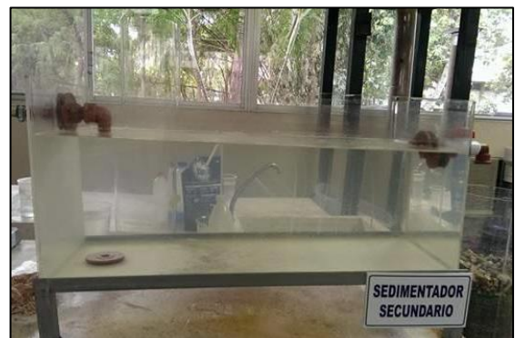
Figura 3.24. Clarificación del agua en el Sedimentador Secundario
