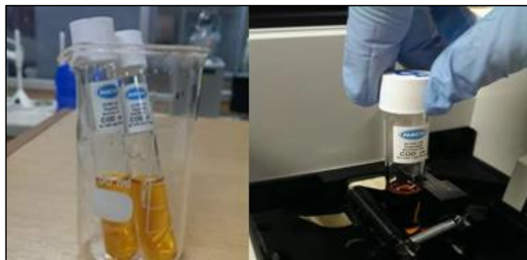
Figura 3.15. Medición de DQO en el espectrofotómetro
