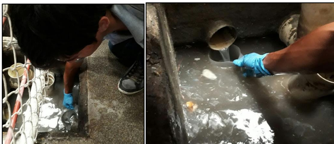
Figura 3.1. Medición de Caudales.
