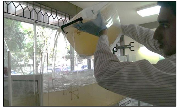
Figura 3.22. Inoculación de Bacterias al Reactor Biológico
