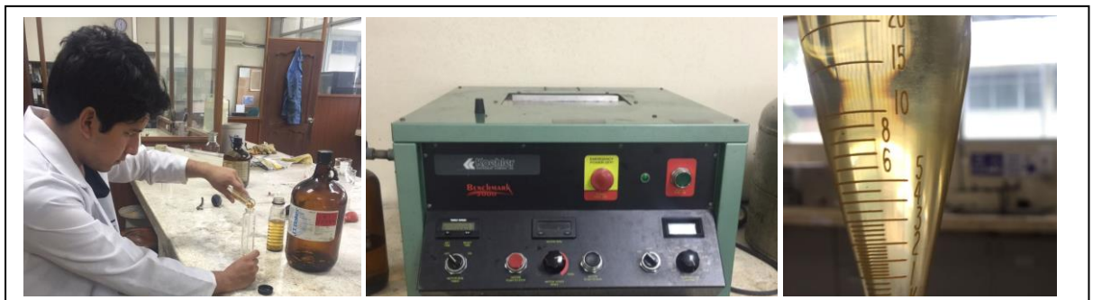
Figura 2.1.3 Determinación de humedad
