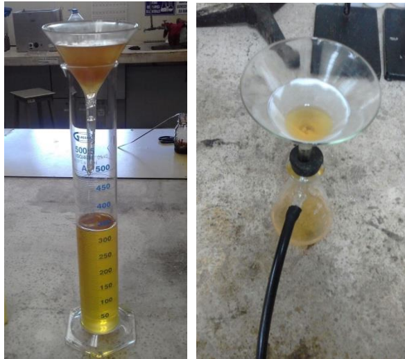
Figura 2.2.1 Filtrado de aceite crudo con lana de vidrio y papel filtro
