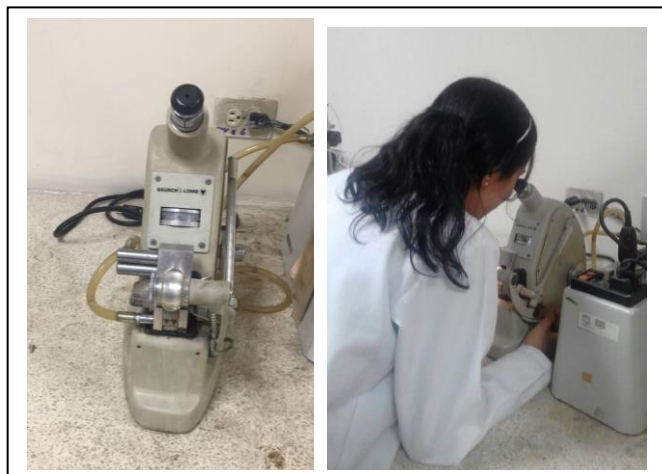
Figura 2.1.7 Refractómetro Baush Lomb Rango (1.3330-1.5041)
