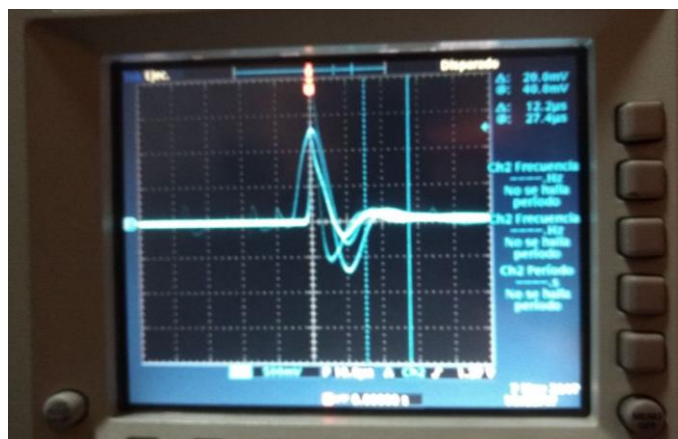
Figura 3.2: Señal de respuesta de corriente y velocidad proveniente de la tarjeta A33.
