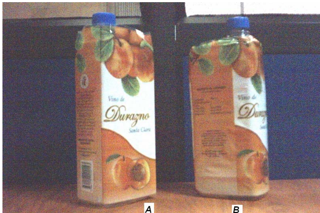
FIGURA 1.2 PRODUCTO ANTES (A) Y DESPUÉS DE TERMOCONTRACCION (B)
