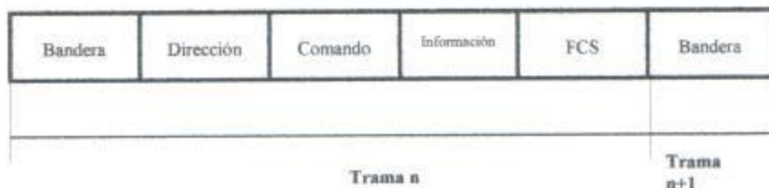
Figura 3.1. Estructura de la trama HDLC (nivel 3)
