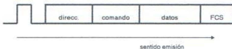
Figura 2.6. Estructura de la trama HDLC (nivel 2)
