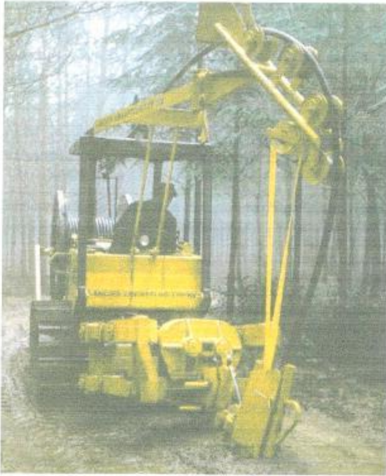
Figura 3.10 Sistema automatizado para tendido directamente enterrado
