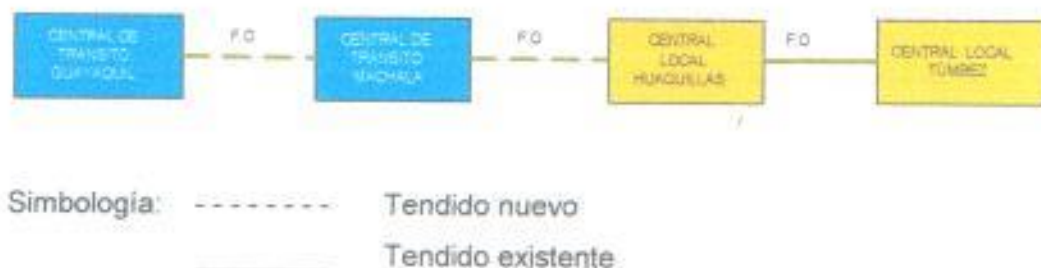
Figura 3.13 Red futura, utilizando fibra óptica como medio de transmisión
