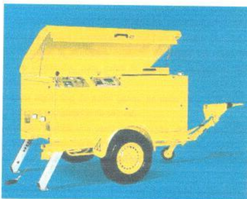
Figura 3.6 Winche para tendido en sistemas de ductos canalizados
