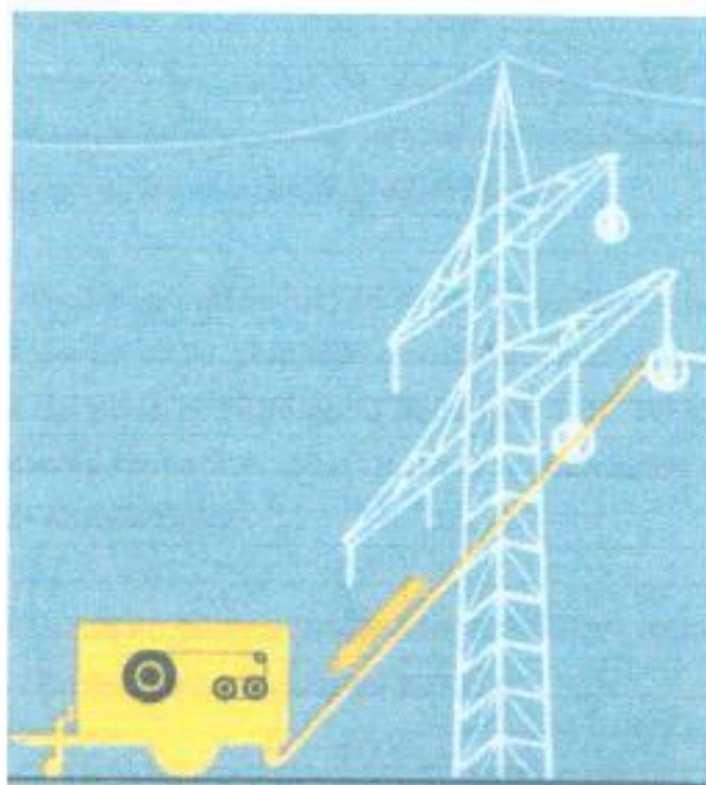
Figura 3.11 Tendido en líneas aéreas de alta tensión
