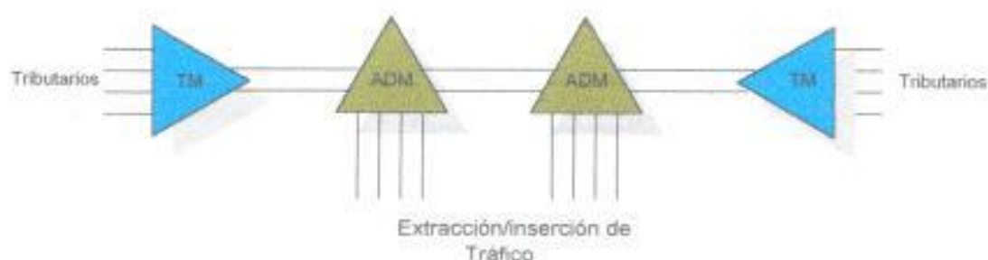
Figura 3.1 Topología tipo bus
