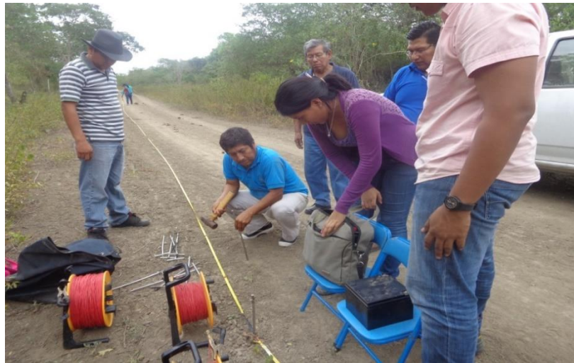
Figura 4. 21 Realización SEVs subcuenca Simón Bolívar Fuente: Toalombo, M., 2016.
