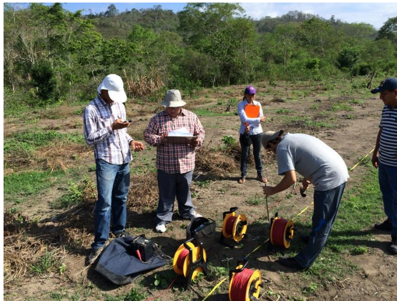
Figura 4. 19 Realización SEVs subcuenca Cadeate Fuente: CIPAT-ESPOL TECH E.P. 2015.
