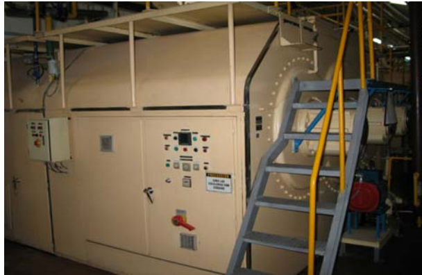
Fig. 1.3.3 CONCHADOR MARCA FRISSE
