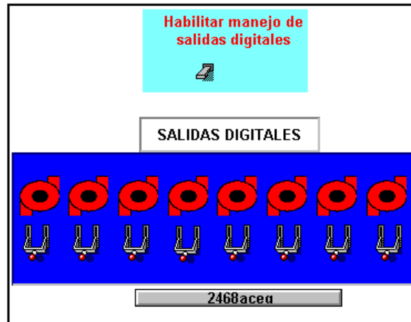
Figura 4- 29.- Interruptores que intervienen en el envío de datos para el control de las salidas digitales.
