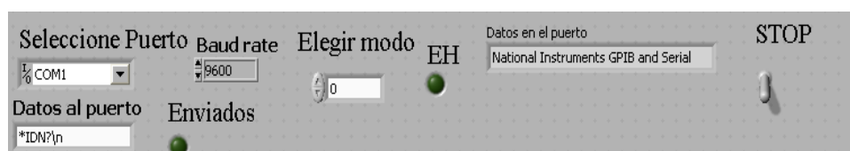
Figura 4- 23.- Parte superior del panel frontal que controla la comunicación con la tarjeta de adquisición de datos.
