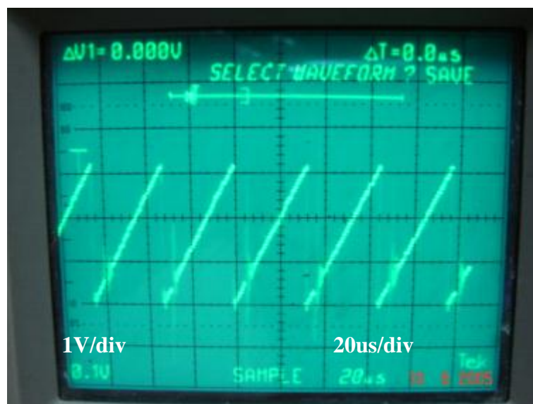
Figura 5-35.- Gráfico de voltaje del pin 5 del C.I TL 494.
