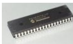
Figura 3- 11.- Foto del PIC 16F877, encapsulado DIP, 40 pines.
