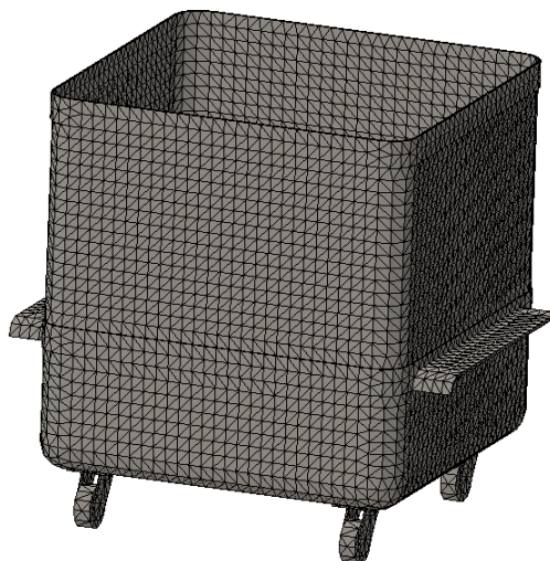
FIGURA 2.46 MALLADO DEL CARRO CONTENEDOR
