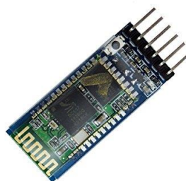
Figura 3.4: Módulo Bluetooth HC-05.
