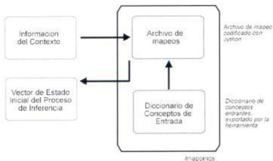
Figura 5.6. Proceso de mapeo de información del contexto en un vector de estado inicial para el motor de inferencias
