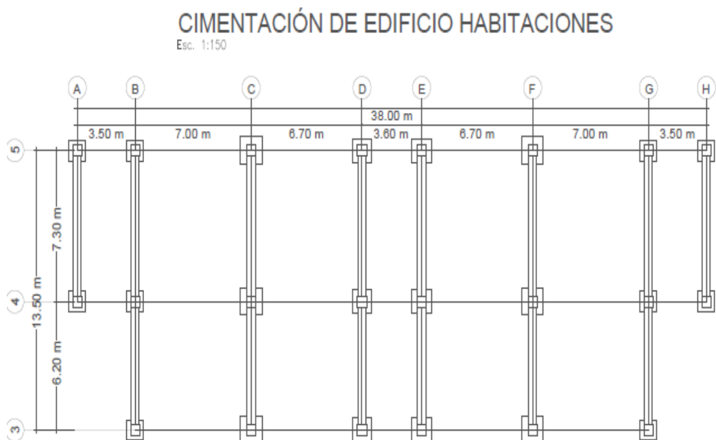
Figura 4.6 Cimentación de edificio habitacional Fuente: Quesada, P., Villacrés, M., 2018.
