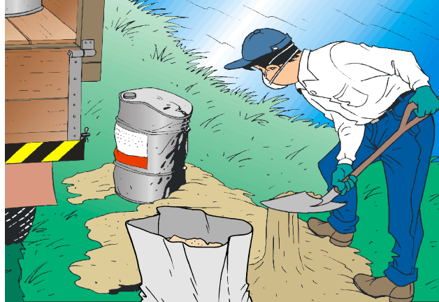
Ilustración 29. Cubrir posibles derrames con arena
