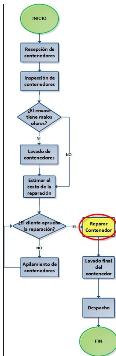
Figura 2.3 Diagrama de flujo del proceso de reparación de estructura de contenedores
