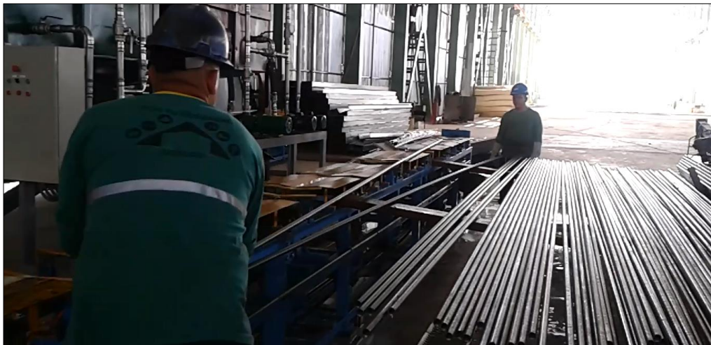
Figura 17: Desalojo Manual, velocidad muy alta o tubos no redondos.
