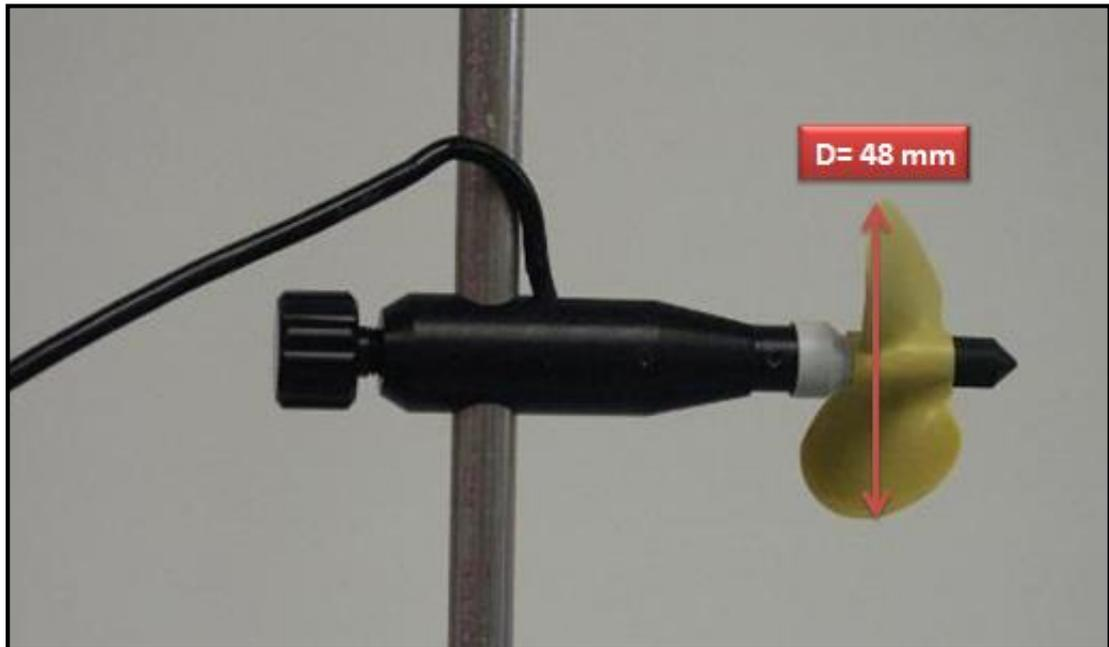
Figura No. 38 Diámetro de la Hélice del Medidor de Velocidad de Flujo
