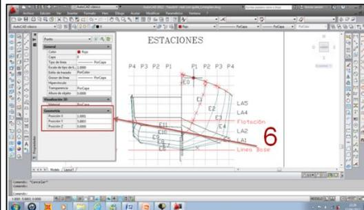
7. En la vista transversal del modelo base, al seleccionar un punto de cualquier estación, se abrirá una ventana en la cual se ingresarán las coordenadas obtenidas en el punto anterior con AutoCad. (esto se debe hacer para todas las estaciones)
