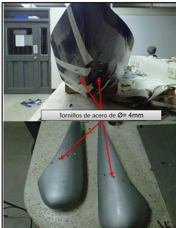
Figura No. 27 Generadores de turbulencia
