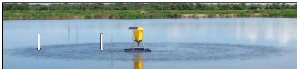
Ilustración 1.4 ¡Error! Utilice la pestaña Inicio para aplicar 0 al texto que desea que aparezca aquí. Distribución del alimento de manera automática, observando el radio que alcanza el alimento al ser administrado, gracias al impacto de los pellets con el agua. Fuente: Ching, 2017
