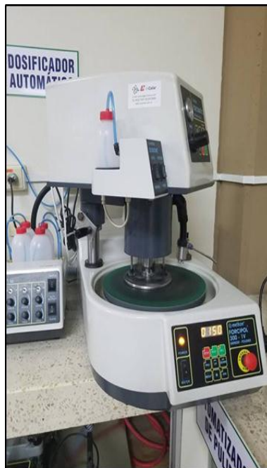
Figura 3.2 Equipo Forcimat para realizar el pulido de las secciones delgadas ubicado en el Laboratorio de Petrografía en ESPOL.
