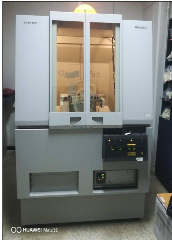
Figura 3.4 Equipo PANalytical X'Pert Pro utilizado para la difracción de rayos x.
