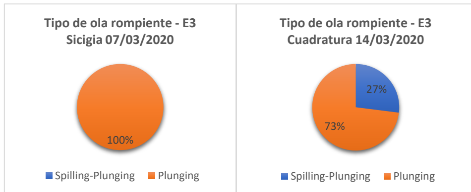
Figura 2.14 Diagrama circular del tipo de ola rompiente observada en la estación E3 durante la fase de sicigia.
