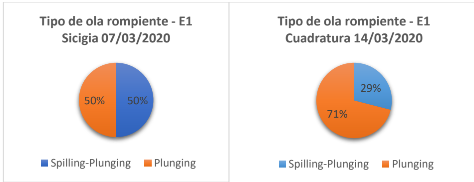
Figura 2.12 Diagrama circular del tipo de ola rompiente observada en la estación E1 durante la fase de sicigia y cuadratura.
