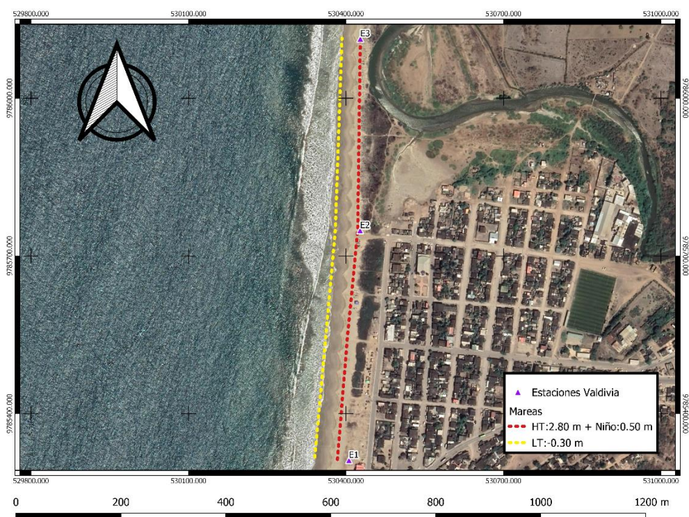
Figura 3.9 Representación de las condiciones de marea máxima y mínima en la playa de Valdivia. La línea roja representa la distancia que alcanzaría el mar en marea máxima y la línea amarilla, la distancia que alcanzaría el mar en marea mínima. Fotografía modificada del 17 diciembre de 2019 de la playa de Valdivia y obtenida de Google Earth.
