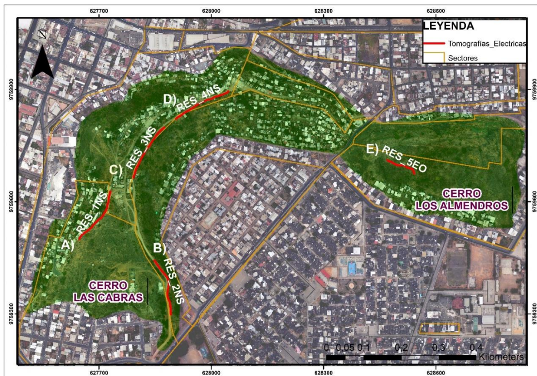
Figura 3.15 Distribución de levantamiento de tomografías eléctricas (línea roja) realizadas en el área de estudio, cuatro de ellas corresponde a el cerro “Las Cabras” A)-B)-C) y D), una de ellas corresponde al cerro “Los Almendros” E). La sombra verde representa el área de estudio.
