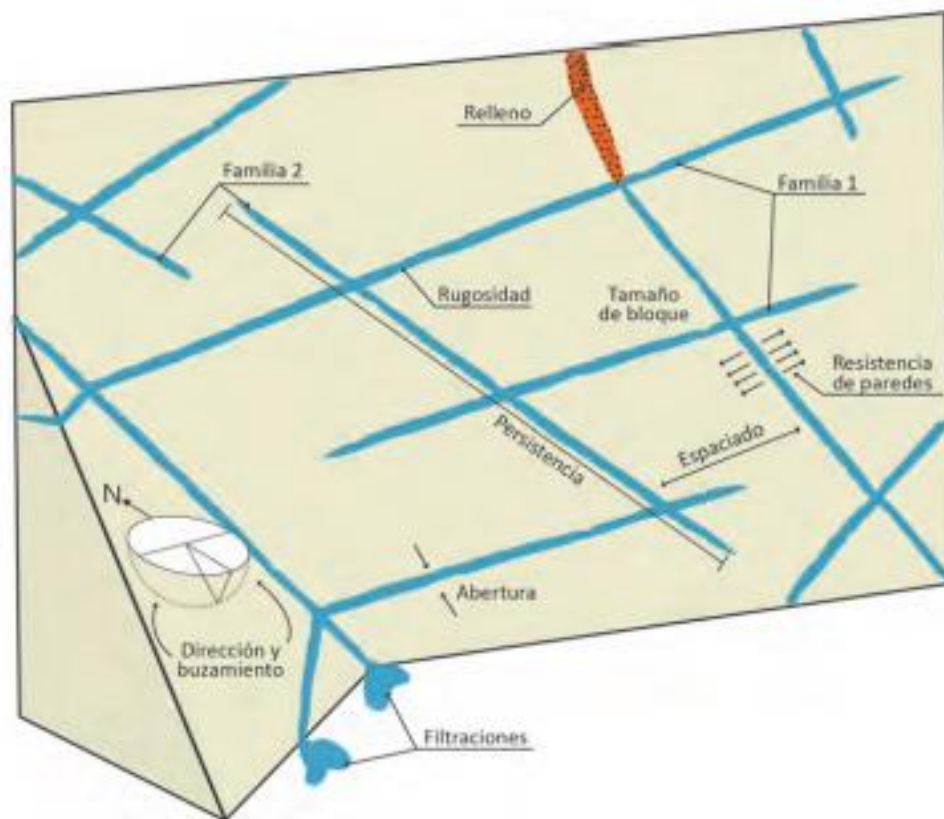
Figura 2.13 Representación esquemática de las propiedades geométricas de las discontinuidades a partir de González de Vallejo et al. (2002).
