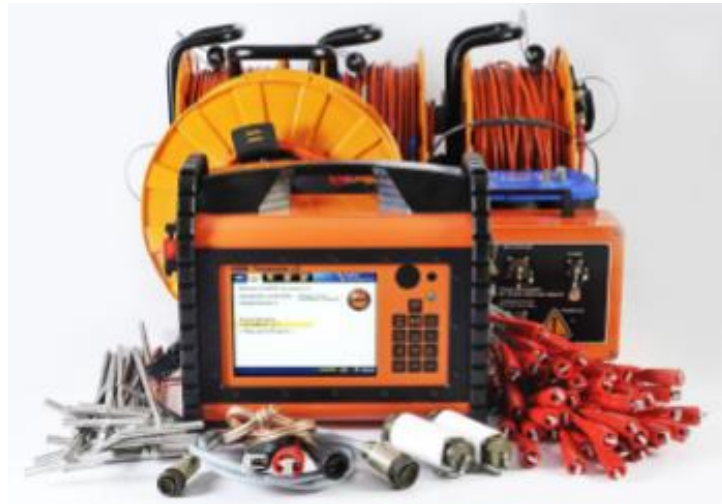
Figura 2.11 Equipo para TER Terrameter LS. Fuente: ABEM, 2012.
