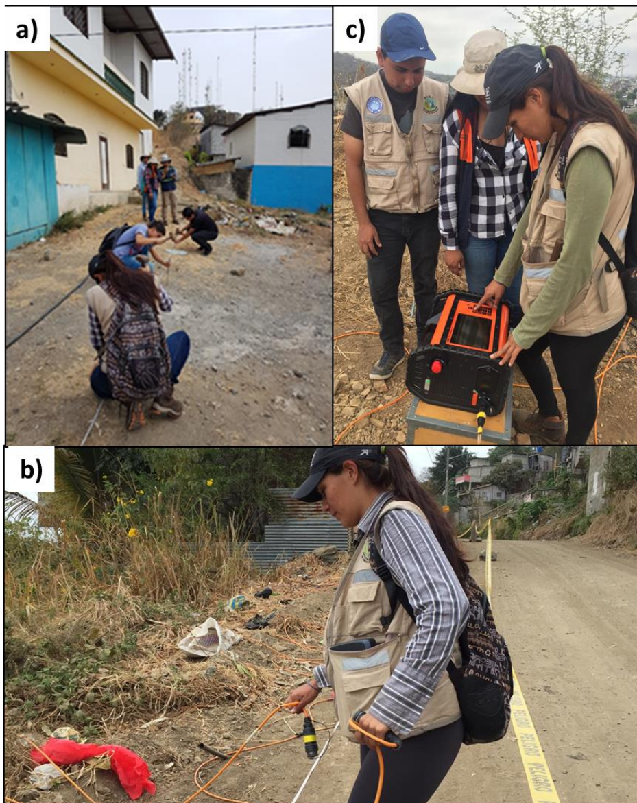
Figura 3.16 Levantamiento de tomografías eléctricas, literal a) Instalación de electrodos para la toma de datos, literal b) arreglo de los cables para la toma de datos, literal c) configuración del equipo para la toma de las Tomografías Eléctricas
