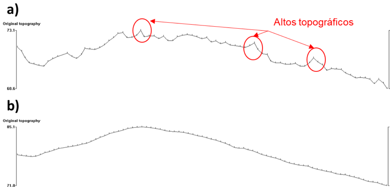
Figura 3.22 Visualización de coordenadas geográficas (x, y, z) del archivo .dat en el software RES2DINV, literal a) muestra codificación del archivo con los datos de equipo navegador GPS Yuma 2, marca Trimble, en este se distinguen altos topográficos y con topografía no cercana a la realidad, y en el literal b) Topografía con la extracción de puntos en el DEM de la ubicación de los electrodos.
