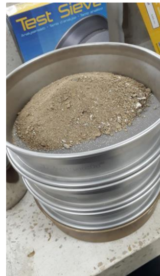
Ilustración 2.8 Orden de los tamices en forma descendiente: tamiz 30,200, 325
