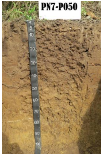
Ilustración 30 Toma de muestras y eliminación de capa orgánica, en este caso 50 cm (parte oscura). (Espinoza, 2018).
