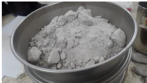
Ilustración 2.9 Ejemplo de muestra con partículas que pueden ser disgregadas
