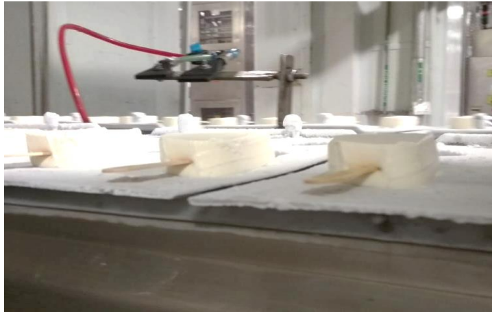
Figura 2.26 Helado con disminución en el grosor por variación de volumen en la dosificación
