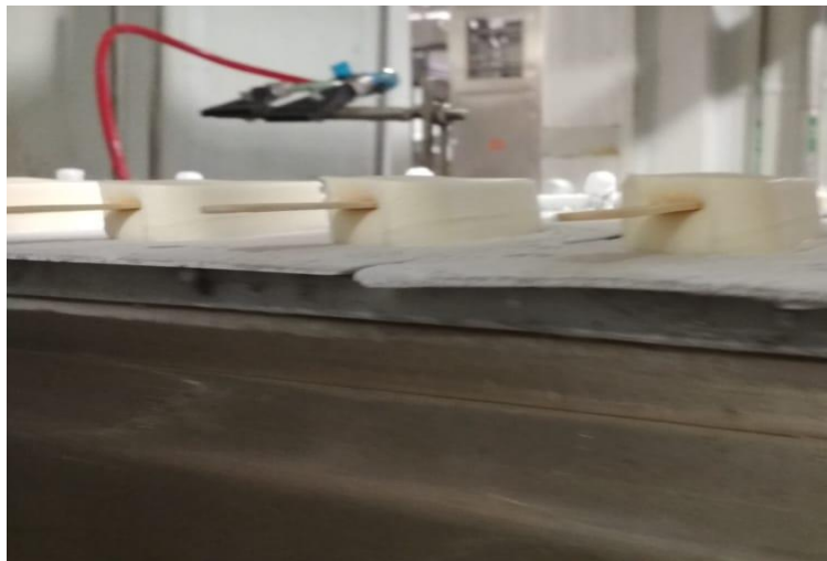
Figura 2.27 Helado con aumento de grosor por variación de volumen en la dosificación del helado
