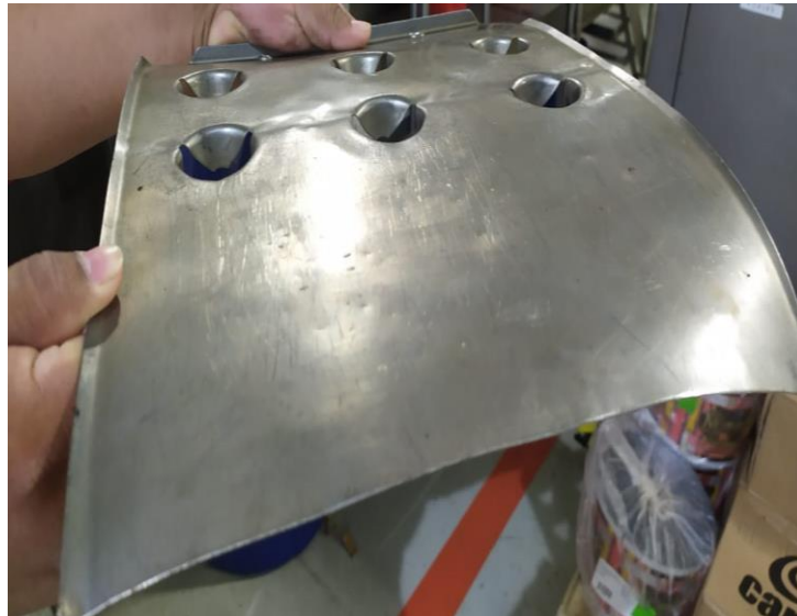
Figura 2.32 Bandeja transportadora de helados doblada
