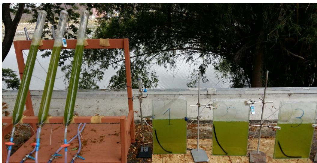
Imagen 3: Cultivo puertas afuera de Chlorella sp. M2 en los fotobiorreactores cilindros y tipo panel.
