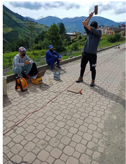
Figura 2.10 Disparo de refracción sísmica [Córdova & Choez, 2021]
