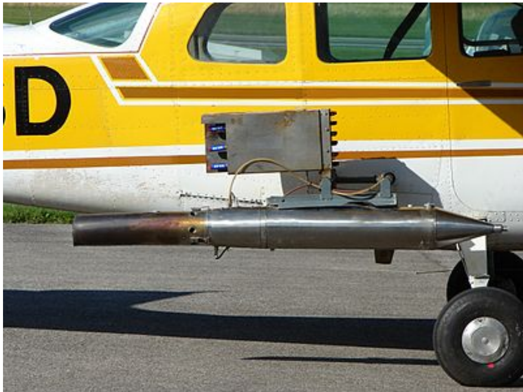
Figura 3.4 Avión monomotor Cessna 210 con el equipo para sembrar nubes
