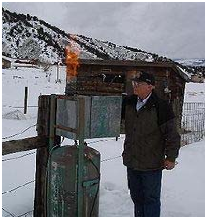
Figura 3.2 Generador de Yoduro de plata para dispersión desde el suelo
