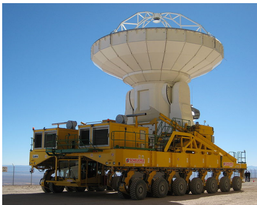
Figura 2.8 Un telescopio siendo transportado en el recinto de la Instalación de Montaje del observatorio Alma en el desierto de Atacama Chile.
