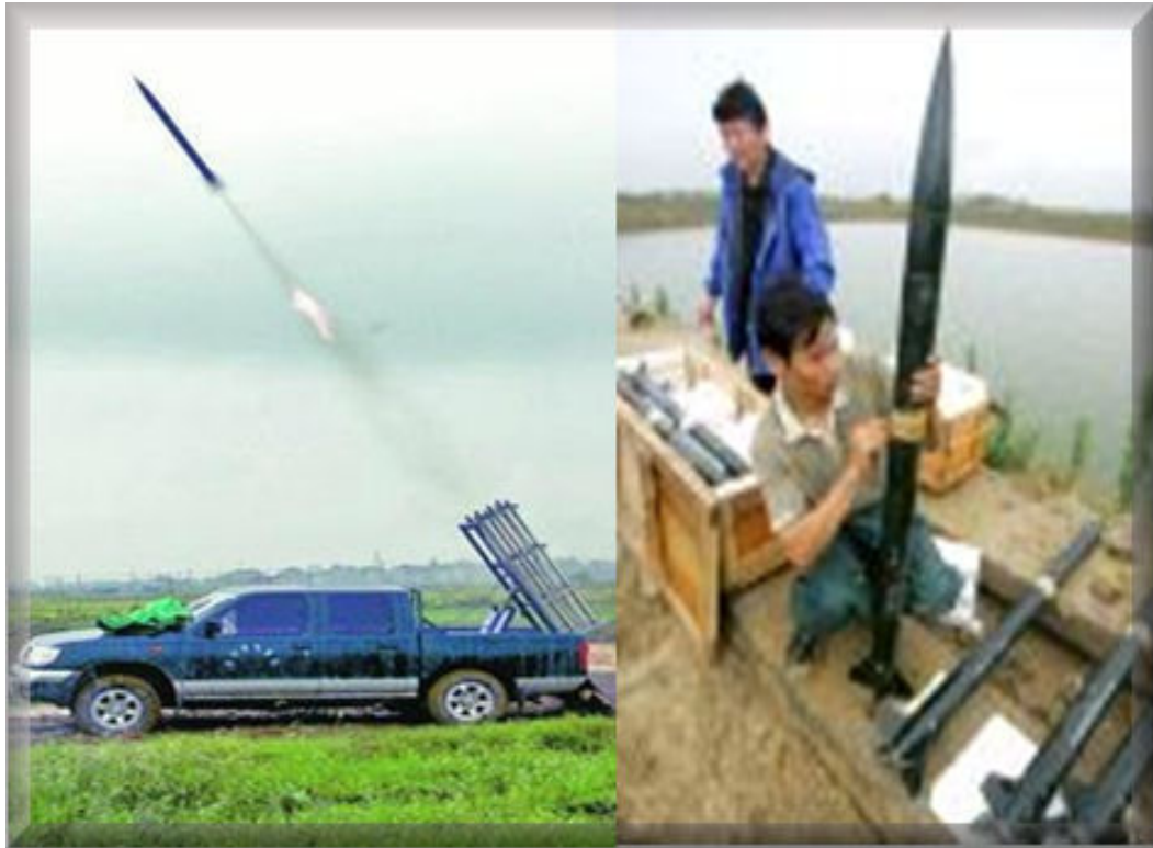
Figura 3.5 Lanzaderas terrestres para bombardeo de nubes
