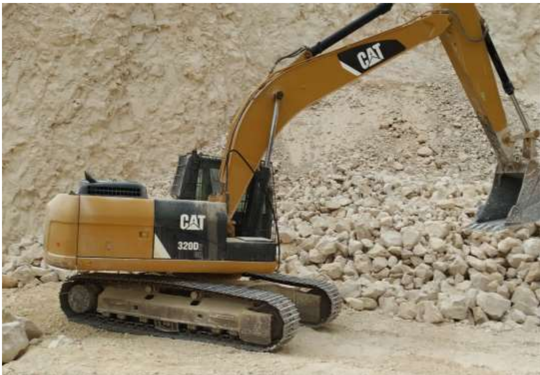
Ilustración 2.2 Excavadora CAT 320D GC
