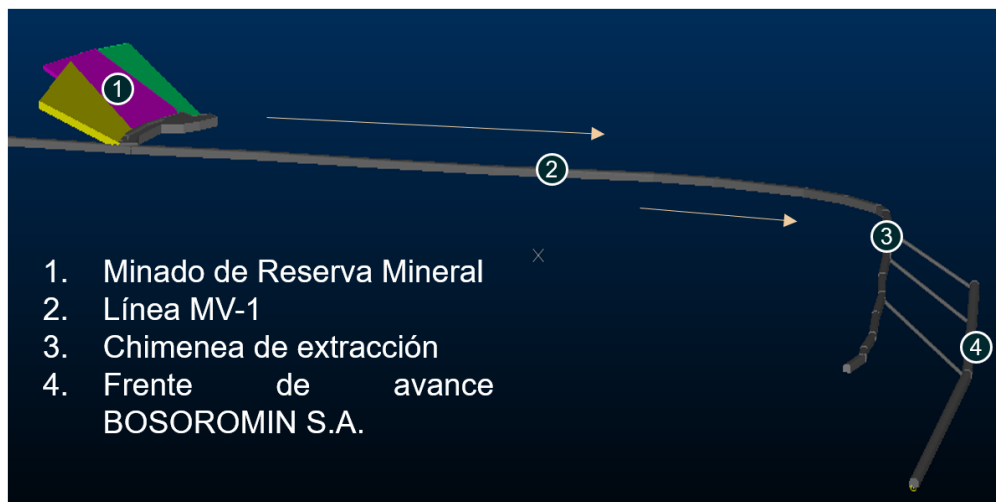
Figura 3.17 Transporte material hacia superficie
